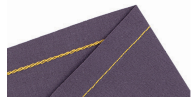
Kettingsteek voor het samennaaien van zeer stevige materialen, voor siereffecten
