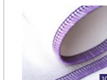
3-draads elastische overlock Voor het naaien van extra elastische dunne of normale stoffen. (Voeg extra elastisch toe door een rekbaar garen te gebruiken in de grippers.)
