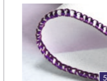
2-draads rolzoom Afwerking van de rand van dunne stoffen. Mooie afwerking op zijde-achtige sjaals, ruches en servetten.
