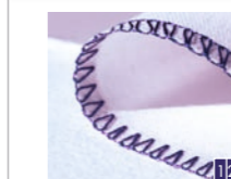
2-draads geroelde overlock breed en smal Werk de rand af voordat u stoffen met een normale rechte steek aan elkaar naait.
