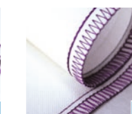
4-draads veiligheidssteek, breed Om stoffen in één stap aan elkaar te naaien met een verstevigde steek en af te werken.
