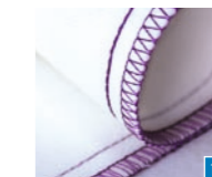
5-draads veiligheidssteek, smal Een duurzame kettingsteeknaad met overlockrand die in één stap wordt genaaid, voor het naaien van kleding, patchwork en andere projecten.
