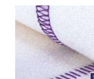
3-draads flatlock, smal Naai elastische stoffen aan elkaar met een decoratief effect, met de flatlock-kant of de laddersteek-kant.
