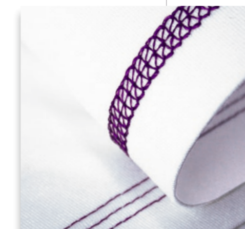
Deksteek breed Voor naden in elastische stoffen en voor decoratieve effecten op alle soorten stoffen. Gebruik decoratief garen in de gripper voor versieringen.
