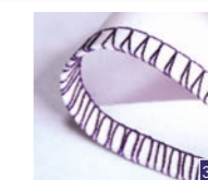
2-draads geroelde overlock, breed en smal Mooie afwerking voor dunne of wollen stoffen.
