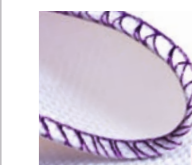
3-draads omgeslagen overlock, smal Perfect voor het afwerken van rokjes of als golftrand op dunne stoffen.
